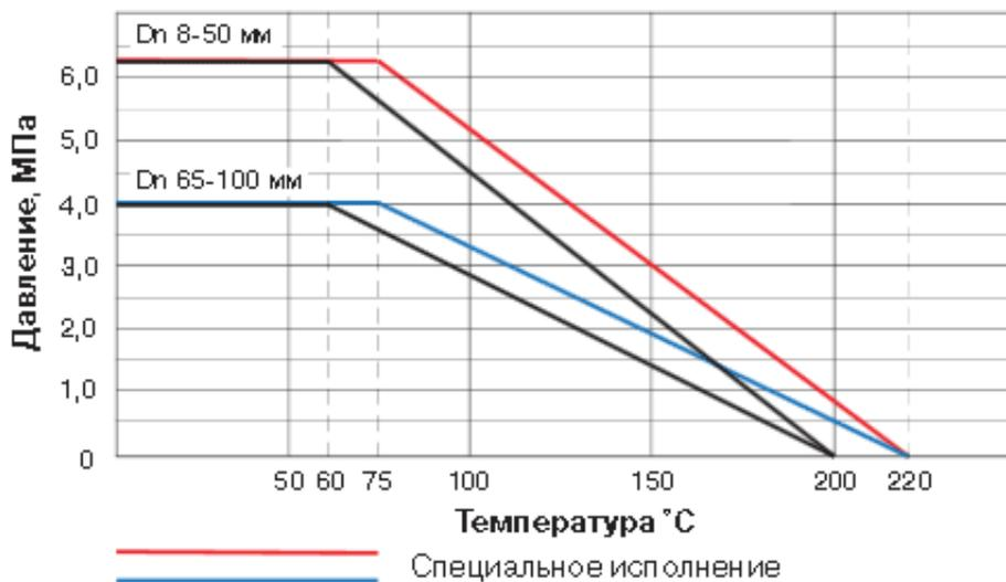
Пример заказа: BV17.04.025.63.c/c – (кран серии BV17, корпус из нержавеющей стали, DN25, PN 6,3 МПа, присоединение под приварку).
